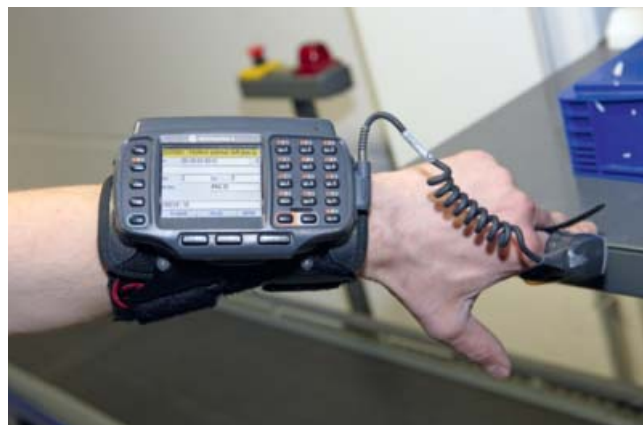
Der MUI genannte Handheld führt den Lagermitarbeiter zum nächsten Warenort. Mit dem Scanner am Finger wird die Lagerentnahme bestätigt.
